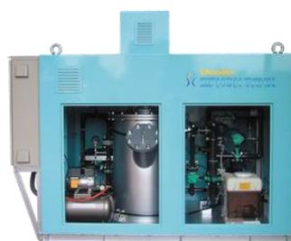
移動式砂ろ過浄水装置
