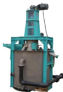
緩速ろ過池ろ過砂洗浄装置
