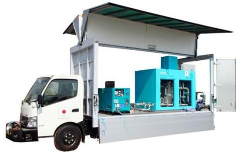
移動式砂ろ過浄水装置（車載時）
