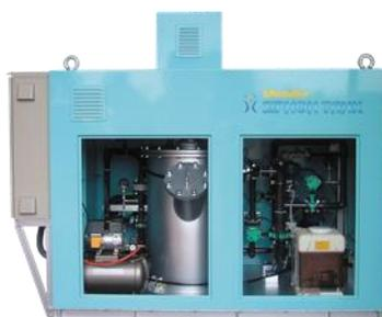
移動式砂ろ過浄水装置
