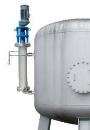
外付け型シフォンろ過砂洗浄機
